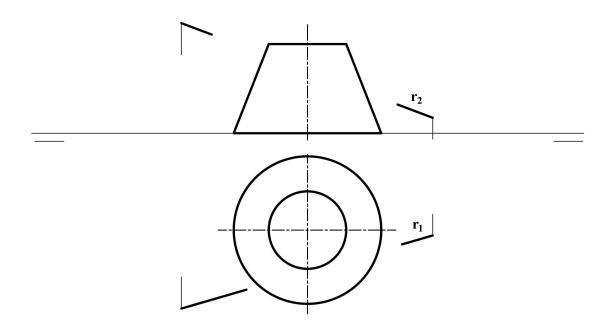
**B2**.- Trazar desde el punto **P** un plano tangente al tronco de cono, determinando las proyecciones de una recta horizontal y una frontal del mismo que contengan a **P**.
