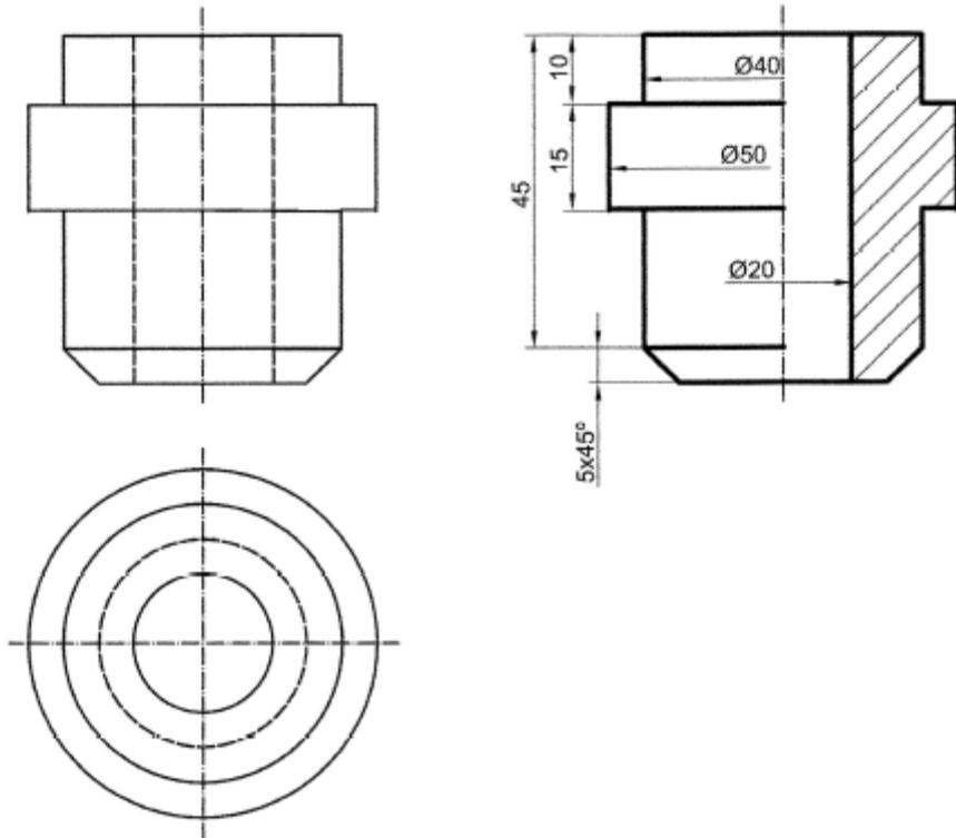
2.- La representación de la figura corresponde a una pieza de revolución con un "corte un cuarto". Acótese, según normas UNE, para su correcta determinación dimensional.
