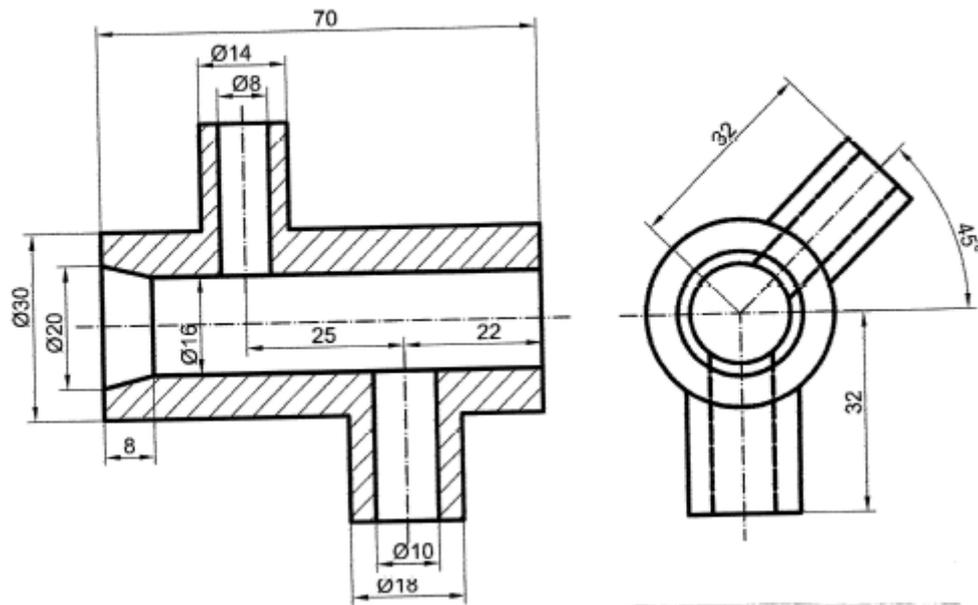
7.- Completar la representación de la pieza añadiendo, sin seccionar, la mitad de la vista que falta y acotar para su correcta definición dimensional. (PAU 2016).
