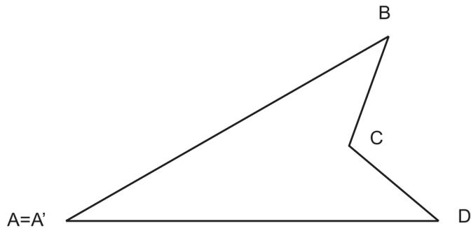
Construir un triángulo semejante al dado ABCD cuyo perímetro sea de 100mm y el lado semejante al AB esté en posición horizontal.
