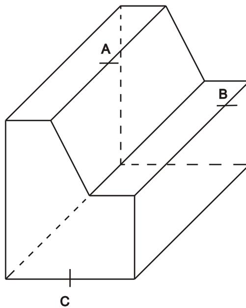
Hallar la sección producida en la pieza dada al ser cortada por el plano definido por los puntos A, B y C.
